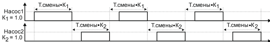
Рисунок 3.4 - Работа насосов при одинаковых коэффициентах хода
